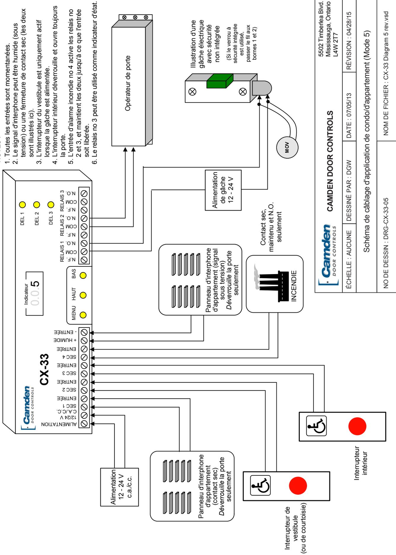
Illustration d'une gâche électrique avec sécurité non intégrée
